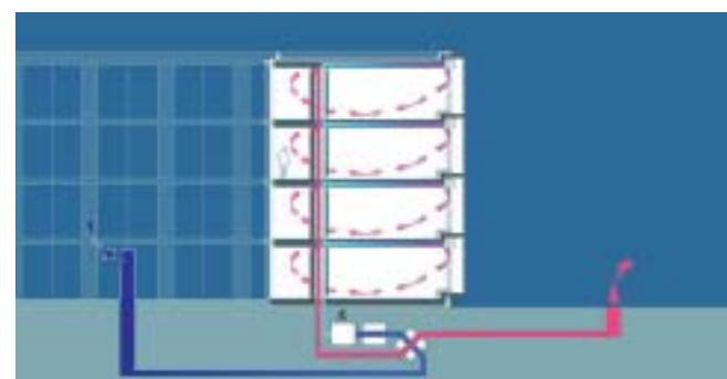
Sommernacht Sommerliche Nachtlüftung zur Aktivierung thermischer Speichermassen
